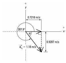
$\vec{v}_{c_f} = 1.18 \text{ m/s} [307.9^\circ]$
